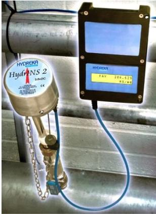
فلومترهای HydrINS برای اندازه گیری جریان در لوله های پر طراحی و ارائه گردیده است. عدم وجود قطعات متحرک مکانیکی و کیفیت بالای مواد بکار گرفته شده در ساخت این نوع از فلومتر موجب گردیده تا اندازه گیری جریان در هر نوع مایع همگن حتی شامل ذرات معلق جامد و مایعات خورنده که فقط هادی جریان الکتریسیته باشند امکان پذیر گردد. این سنسور ها بوسیله فیتینگهای استاندارد و یا بصورت **Hot tap** در مسیر جریان به سرعت و به آسانی نصب میشوند .
